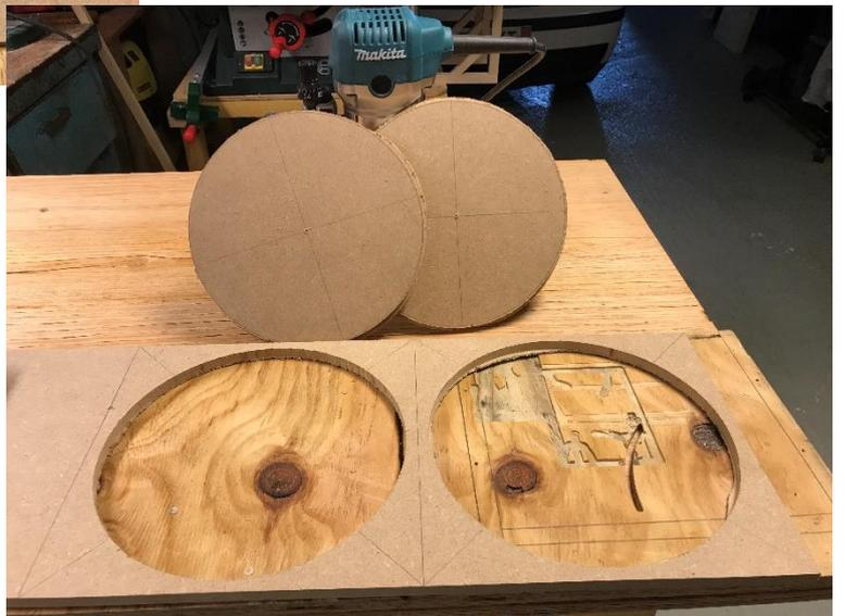
Finition du bord du disque avec une bague à copier
